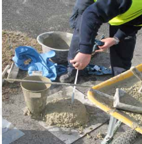
Consistencia estática, cono de Abrams
